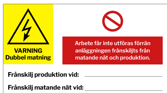
Bild 18. Exempel på skylt som varnar för bakspänning, används när elkopplaren inte sitter i mätarskåpet. Används främst vid strömtrafomätta anläggningar.
