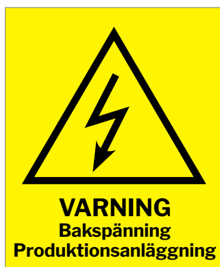
Bild 16. Exempel på skylt som varnar för bakspänning på anläggningen.
